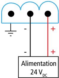
Modèles 24 V<sub>AC</sub> utilisant des convertisseurs d'alimentation :
