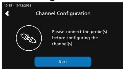
Connecter une sonde pour configurer une voie et appuyer sur **"Suivant"**.
