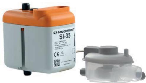
Gracias a su elevado caudal (30 l/h), la Si-33 se adapta a cualquier climatizador de una potencia superior a 20 kW, hasta 30 kW. El núcleo de bomba de la Si-33, diseñado específicamente para la evacuación de los condensados, resiste en cualquier tipo de entorno.
