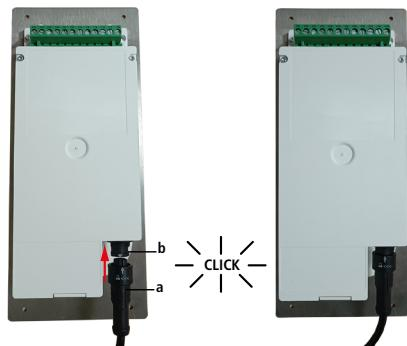
Een sonde loskoppelen van de transmitter Si-CPE320
