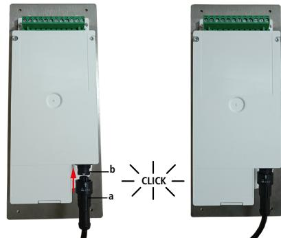
Trennen einer Sonde vom Si-C320 Transmitter
