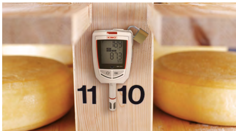
Contrôle en humidité relative et température en cave d'affinage, assuré par un KT 220 fixé sur platine de fixation et sécurisé par un cadenas dans le cadre d'une cartographie.
