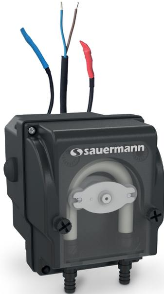
Diese peristaltische Pumpe ist für alle Arten von Klimaanlage bis zu 8 kW geeignet: Wandgeräte, Klimaschränke, Deckengeräte und Kanalgeräte. Ausgestattet mit zwei Ferntemperatursensoren wird die Si-51 aktiviert, wenn der Temperaturunterschied zwischen der in das Klimagerät eintretenden und der aus ihm austretenden Luft mehr als 6 °C beträgt. Die Pumpe läuft 4 Minuten lang weiter, wenn der Temperaturunterschied unter 6 °C fällt.
