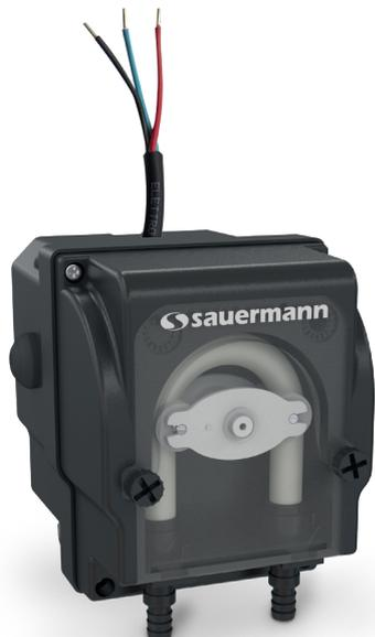
Questa pompa peristaltica è progettata per tutti i tipi di condizionatori fino a 8 kW: unità a parete, armadi di condizionamento, unità a soffitto e canalizzate. La Si-50 è controllata dal segnale di alimentazione del compressore del condizionatore e continua a funzionare per 4 minuti dopo l'arresto del compressore.
