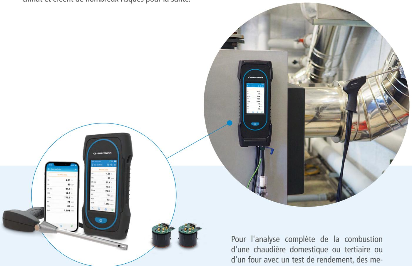
Pour l'analyse complète de la combustion d'une chaudière domestique ou tertiaire ou d'un four avec un test de rendement, des mesures des émissions de CO et de NO<sub>x</sub>, un calcul du CO<sub>2</sub> avec une surveillance de CO ambiant, ainsi que des mesures de tirage (pression) et de température.
