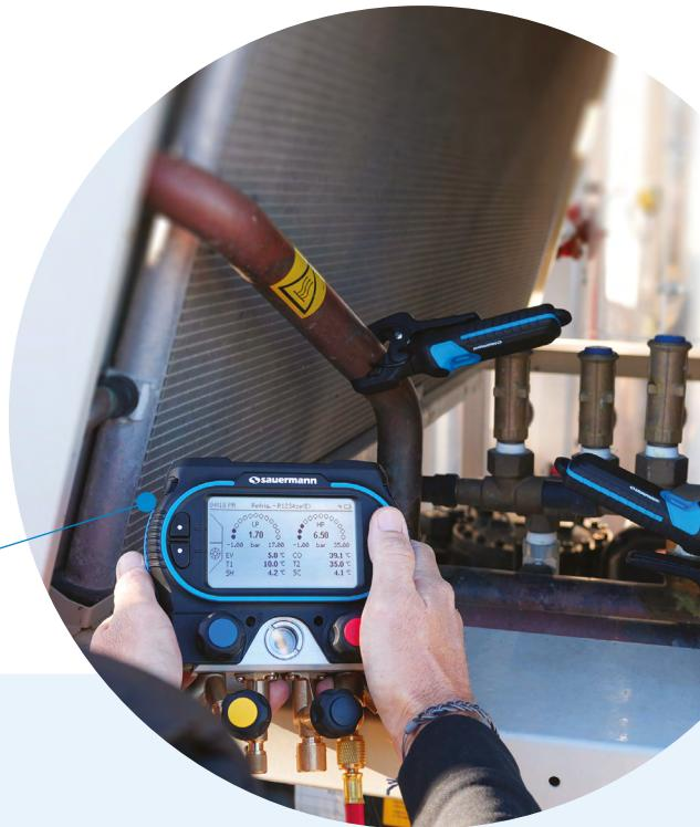
Esta herramienta permite al usuario poner en marcha una bomba de calor, comprobar la estanqueidad del circuito de refrigerante o llenar el gas y comprobar la presión diferencial y las temperaturas de subenfriamiento/sobrecalentamiento simultáneamente.
