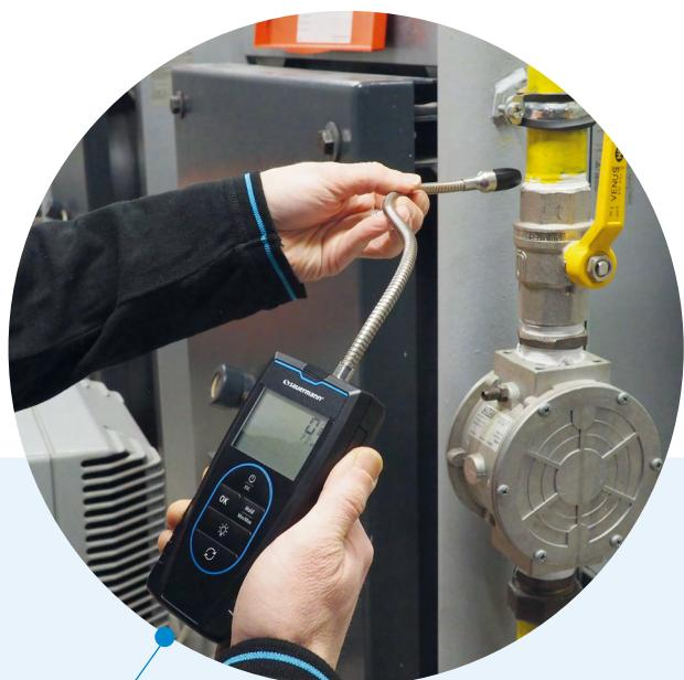
Detecta la mayoría de las fugas de gas refrigerante en el bucle de gas de una bomba de calor.
