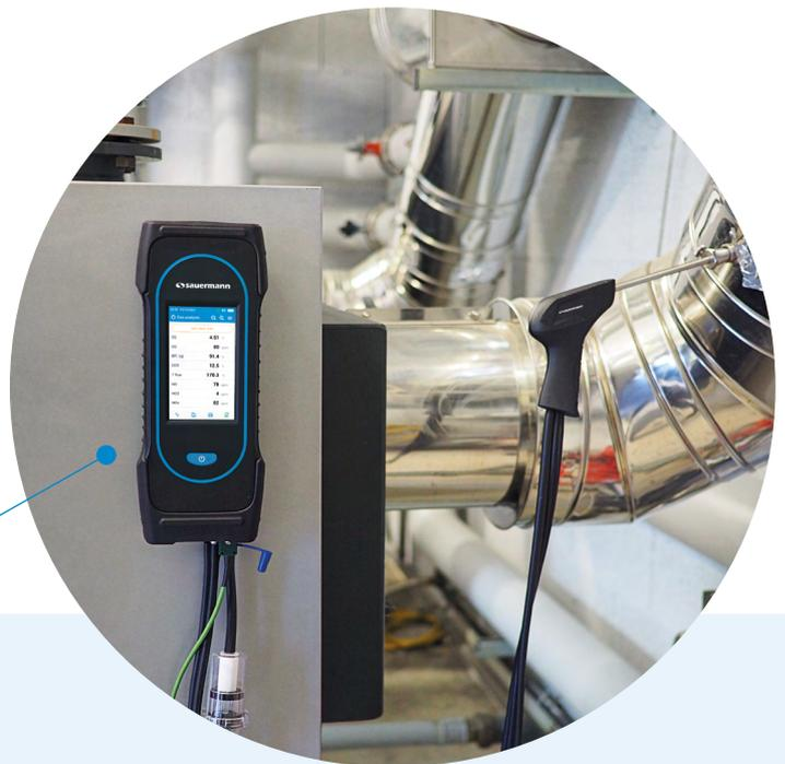
Für die vollständige Analyse der Abgase einer Heizungsanlage in einem Wohngebäude oder einem Dienstleistungsgebäude bzw. eines Ofens mit einem Wirkungsgradtest, Messungen der CO- und NO<sub>x</sub>-Emissionen, einer Berechnung des CO<sub>2</sub>-Gehalts und Überwachung der CO-Konzentration in der Raumluft sowie Messungen des Kaminzugs (Druck) und der Temperatur.
