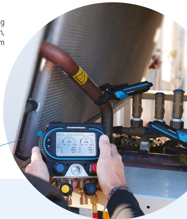
Mit diesem Gerät kann der Benutzer eine Wärmepumpe in Betrieb nehmen, die Dichtigkeit des Kältemittelkreislaufs oder des Füllgases überprüfen und gleichzeitig den Differenzdruck und die Unterkühlungs-/Überhitzungstemperaturen kontrollieren.
