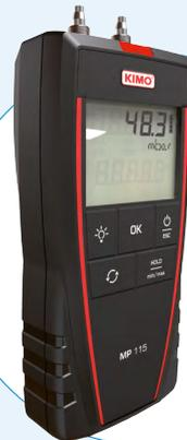
Zur Messung des Drucks am Gaseinlassventil, des Kaminzugs des Kessels oder Ofens und des Differenzdrucks über einen Filter oder einen anderen Teil des Verbrennungssystems, um dessen ordnungsgemäße, sichere und effiziente Funktion zu überprüfen.
