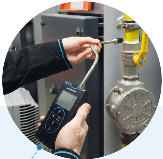
Zur Erkennung von Lecks von Brenngas wie Erdgas, Methan, Propan, Isobutan und Flüssiggas im Gasleitungssystem eines Heizkessels.
