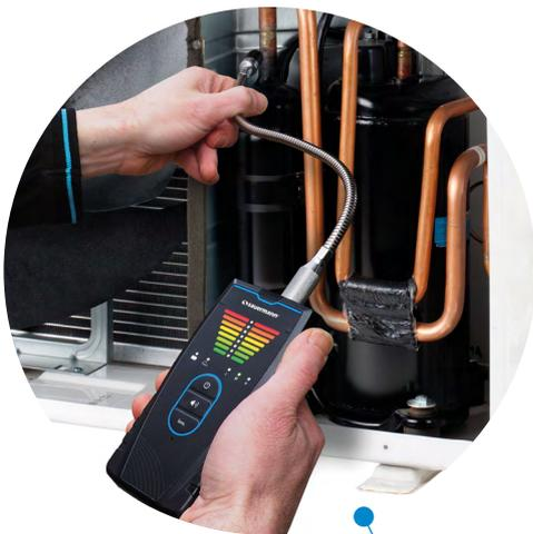
Zum Aufspüren der meisten Kältemittelgaslecks im Gaskreislauf einer Wärmepumpe.
