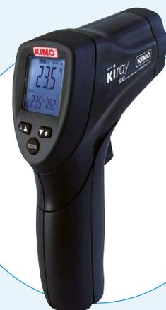
Zur Messung der Temperatur des Vor- und Rücklaufwassers eines Wärmekreisverteilsystems.
