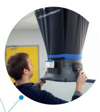
控制房间通风口处的风量,使其保持动态平衡并计算房间内的换气率。同时,控制环境温度和湿度。
