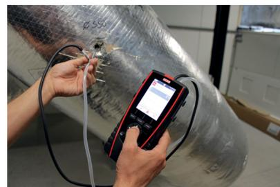
Medición de presión con tubo de Pitot
