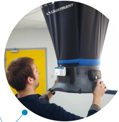
Contrôle du débit d'air à l'entrée et à la sortie d'une pièce, équilibrage de la ventilation et calcul du taux de renouvellement d'air. Contrôle également la température et l'hygrométrie de l'air.
