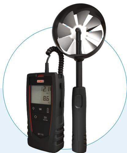
Mesure de débit et vitesse au niveau des bouches de ventilation (sauf diffuseur).
