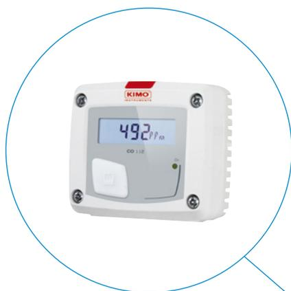
Surveillance de la concentration de dioxyde de carbone au sein de l'air en circulation dans les conduits d'extraction d'air. Permet au système de gestion du bâtiment de réguler les flux de ventilation pour assainir l'air intérieur
