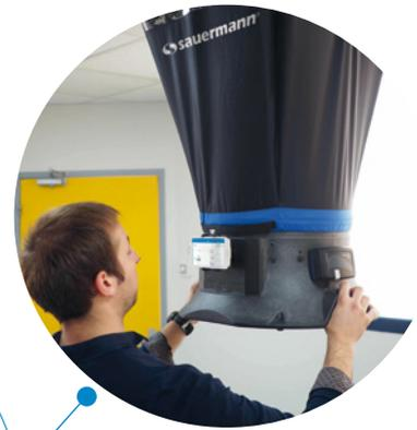
Überprüfung des Luftvolumenstroms am Ein- und Ausgangeines Raumes, Ausgleich der Lüftung und Berechnung der Luftwechselrate. Außerdem Überprüfung von Temperatur und Luftfeuchtigkeit.
