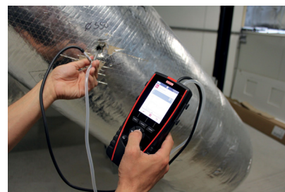
Medición de presión con tubo de Pitot
