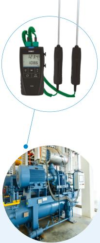
Calcule de la surchauffe et du sous-refroidissement d'un système de refroidissement à changement de phase avec un thermomètre à double entrée, en utilisant un manifold analogique.
