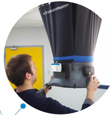
Control del caudal de aire a la entrada y salida de una habitación, equilibrado de la ventilación y cálculo del índice de cambio de aire. También controla la temperatura y la higrometría del aire.
