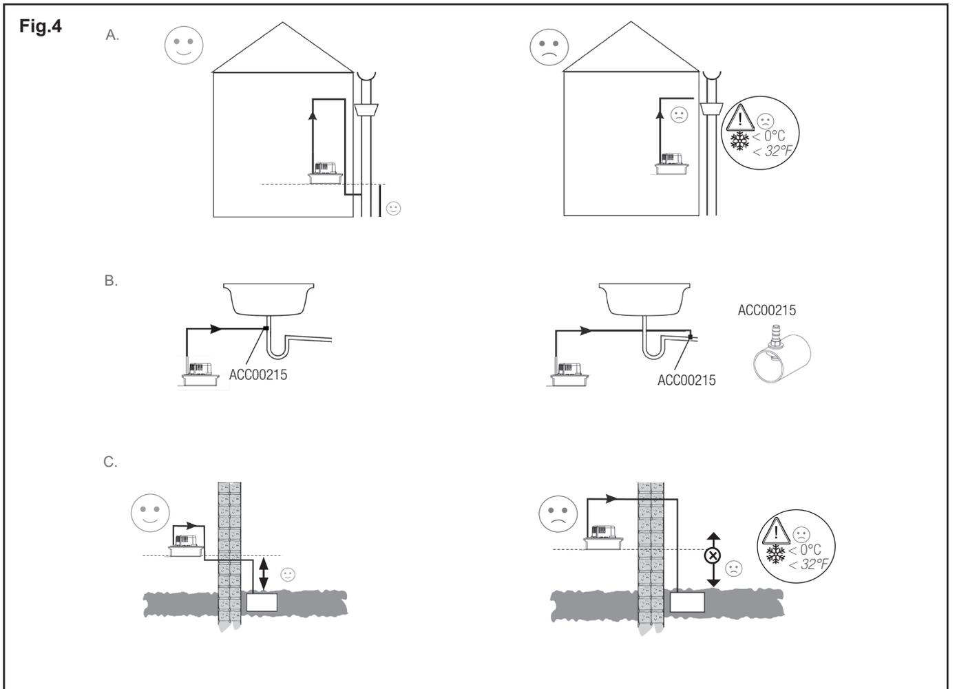
Les pompes de relevage de condensats SI 1805 sont destinées à relever des condensats chargés. Elles sont particulièrement adaptées aux armoires frigorifiques, consoles, évaporateurs, vitrines réfrigérées, chaudières à gaz dont les condensats n'ont pas un PH inférieur à 3,4. Ce sont des pompes centrifuges monobloc.
