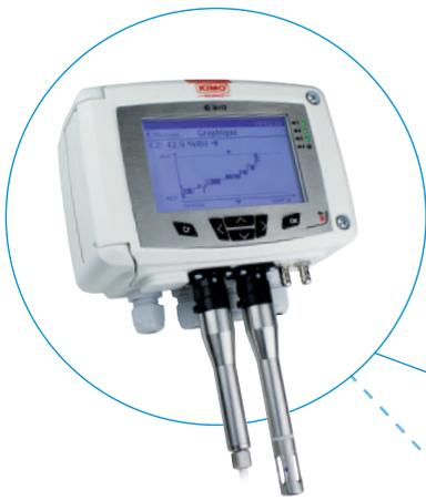
监测和调节通风与空调管道中的动压、温度、湿度和其他相关参数(露点,热焓值,混合比等)。
