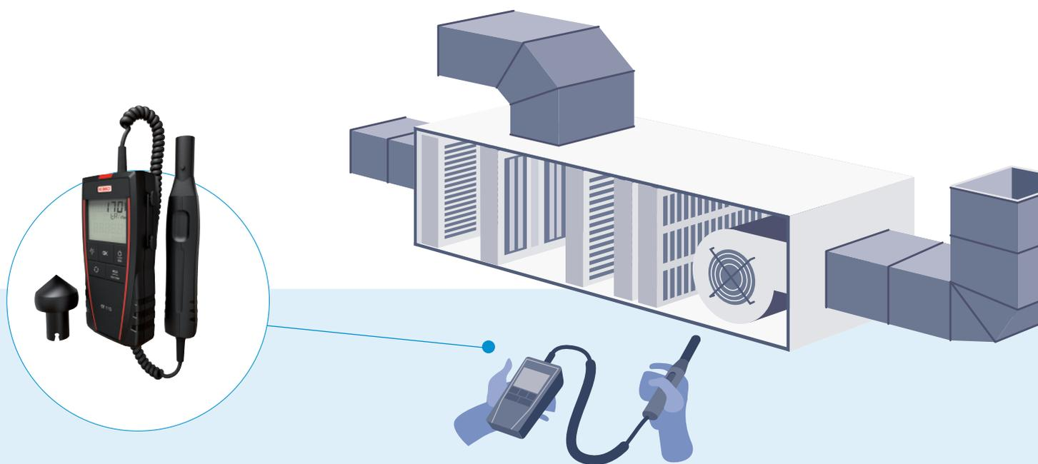
例如: 测量通风与空调系统中电机和风扇的转速。
