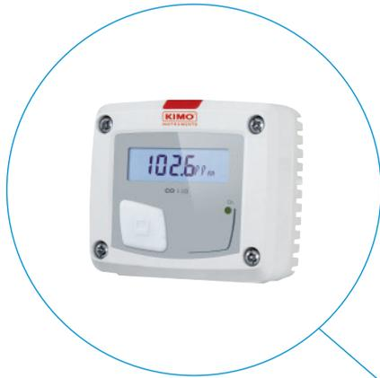
通过监测排风管道（回气端）内循环空气的 CO<sub>2</sub> 浓度，使建筑物中央控制系统能有效调节通风与空调系统的风量，保持室内空气洁净。
