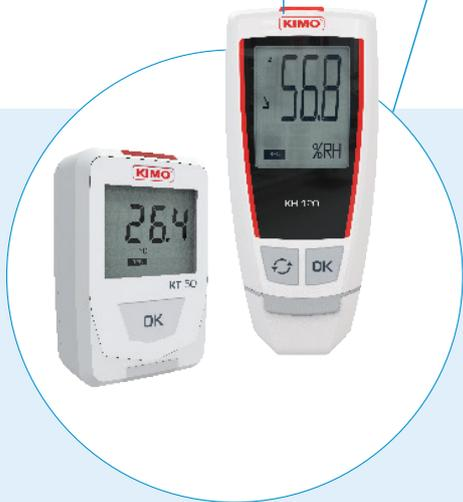
使用记录仪监测仓库或储存间内的温度。通常情况下，多个记录仪会被放置在仓库的不同位置，以便获取详细的温度分布数据，用于构建和分析区域温度趋势。有些记录仪可单台同时测量和记录最多 4 个温度数据。
