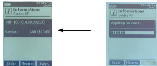
探头信息显示在屏幕上。按功能键“测量”进入测量模式屏幕，按功能键“删除”可删除此无线探头。
