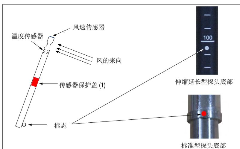
使用任何风速探头前，请将传感器保护盖 (1) 下拉 (叶轮型探头除外)。
