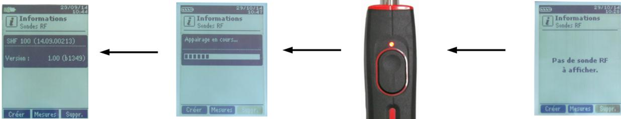
探头信息显示在屏幕上。按功能键“测量”进入测量模式屏幕，按功能键“删除”可删除此无线探头。
