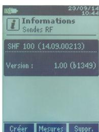
La información de la sonda se muestra con la tecla de función "Mediciones". Es posible hacer una copia de la pantalla de medición. También es posible borrar la sonda inalámbrica pulsando la tecla de función "Borrar".
