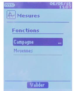
Una campaña o registro de mediciones consta de varios puntos de medición con fecha y hora de registro. Puede seleccionar entre registro automático o manual.
