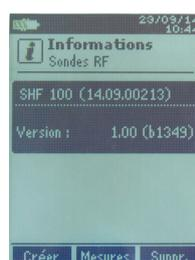
La información de la sonda se muestra con el tecla de función "Mediciones". Es posible hacer una copia de la pantalla de medición. También es posible borrar la sonda inalámbrica pulsando la tecla de función "Borrar".
