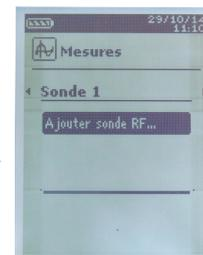
Con el teclado de flechas, seleccione "Añadir sonda RF..." y pulse **OK**
