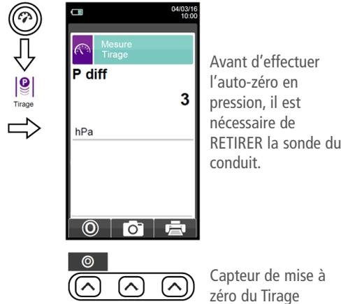
Avant d'effectuer l'auto-zéro en pression, il est nécessaire de RETIRER la sonde du conduit.
