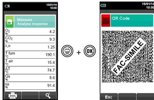
Scanner le QR code en utilisant l'application E Instruments "Application QR code E-Instruments", pour télécharger les données relatives aux moyennes des analyses et aux mesures additionnelles si elles ont été réalisées.
