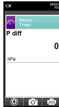
Une fois que l'auto-zéro en pression est effectué, insérer la sonde dans le conduit et mesurer le tirage.
