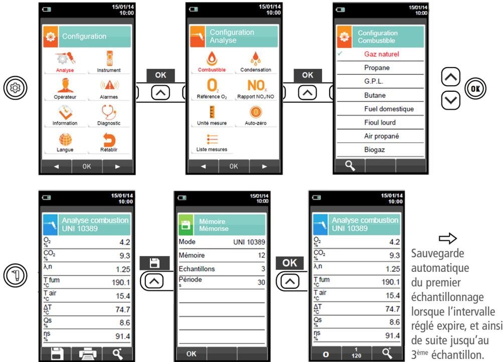
→ Sauvegarde automatique du premier échantillonnage lorsque l'intervalle réglé expire, et ainsi de suite jusqu'au 3<sup>ème</sup> échantillon.
