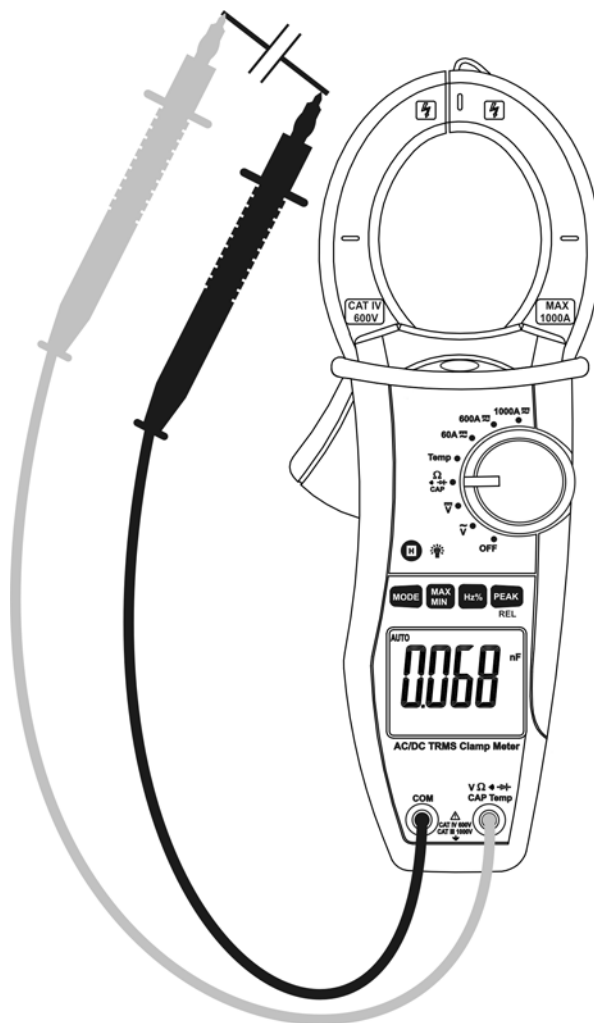
Fig. 7 : Mesure de capacité
