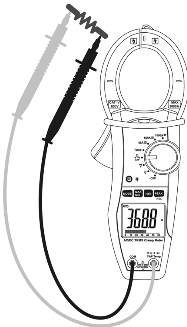
Fig. 5 : Mesure de résistance
