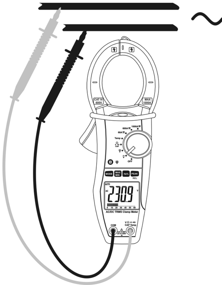
Fig. 3 : Prise de mesure de tension alternative
