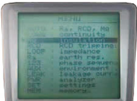
Menu général permettant d'accéder rapidement aux fonctions possibles dans l'instrument. (modèles COMBI419 et COMBI420 uniquement)
