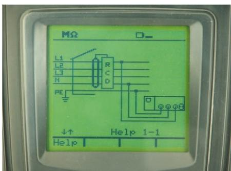
Aide en ligne (disponible pour chaque fonction) pour guider l'utilisateur au raccordement de l'instrument à l'installation à contrôler
