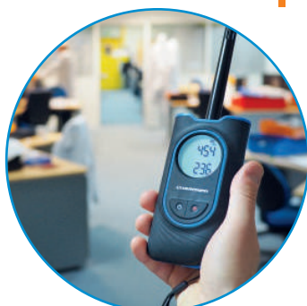
测量环境温度和湿度 (计算露点温度, 湿球温度)
