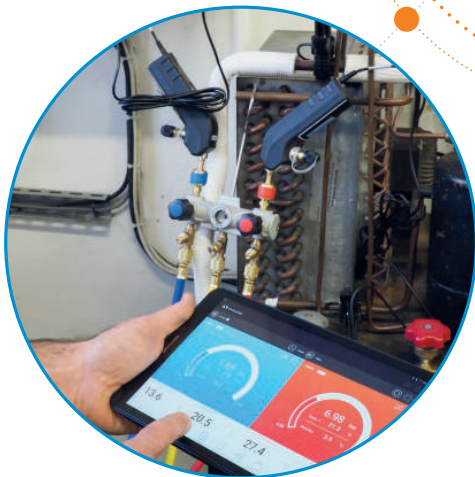
使用 SI-RM13 冷媒表组 执行测量和检查
