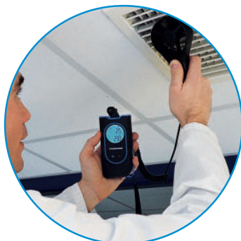
测量格栅处的风速, 风量和温度
