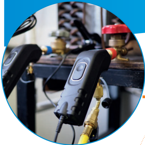
使用 SI-RM3 测量 冷却装置
